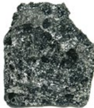
Bei 1500 °C verkochte Binderproben, REFRAFLEX®
